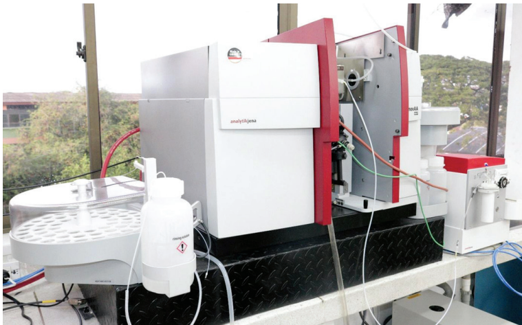
Figura 2.11. Equipo de Absorción atómica. Laboratorio de investigación -CORHUILA. Fuente propia.
