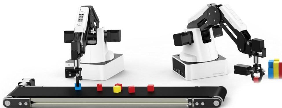
Imagen 18 - Robot DObot Magician de 4 GDL
