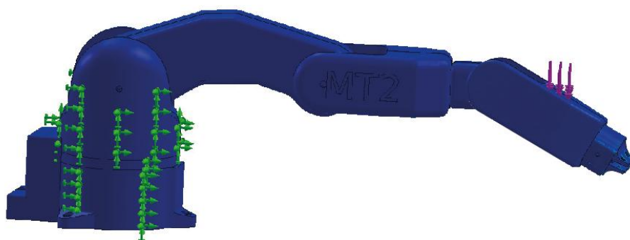
Imagen 24 - Análisis Estático – Carga aplicada en muñeca
