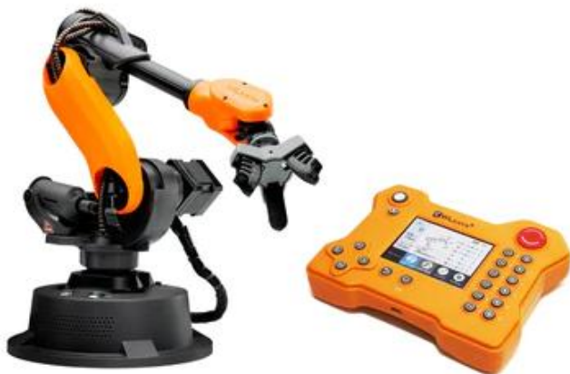
Imagen 16 - Robot Wlkata Mirobot – Brazo robótico de 6 GDL
