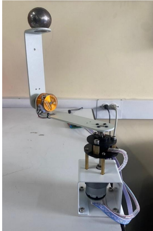
Figura 2 - Cinemática del péndulo invertido rotatorio.
