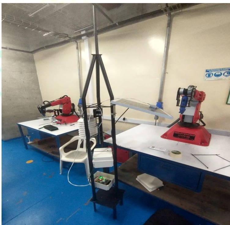
Ilustración 7. Estación Meteorológica totalmente conectada a circuitos de conexión de sensores y módulo de comunicación UC20(Ensamble en el laboratorio de ingeniería Mecatrónica “Corhuila-Prado Alto”).
