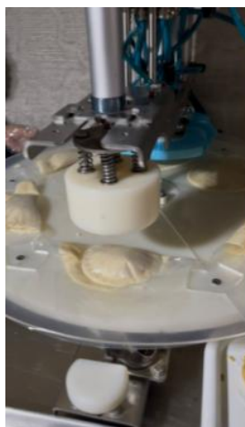
Figura 7. Máquina formadora de empanadas semiautomática de mesa (o simplemente formadora de empanadas tipo prensa).
