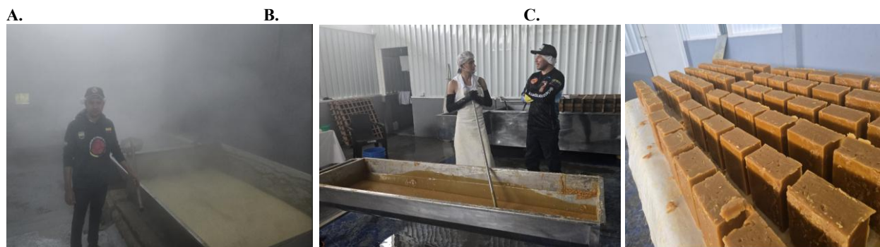
Figura 6. A. Batido de jugo de miel de panela. B. Moldeado de panela. C. Secado de Panela
