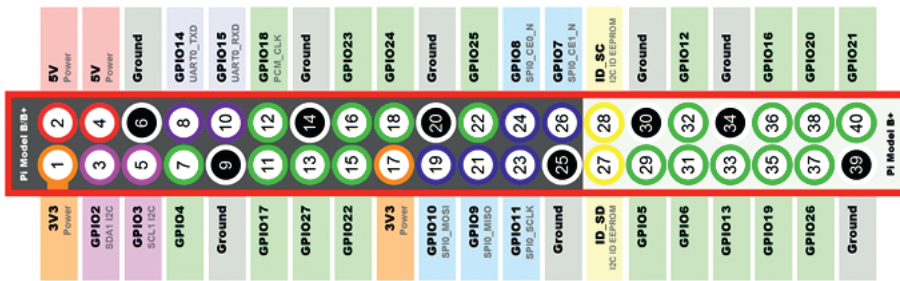
Figura 6. Distribución de los buses GPIO de la Raspberry Pi 3.
