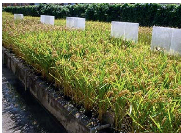
Figura 10. Cámaras construidas para el monitoreo de la emisión de gas metano.
