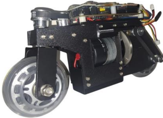
Figura 11. Diseño final del prototipo de motocicleta autónoma.
